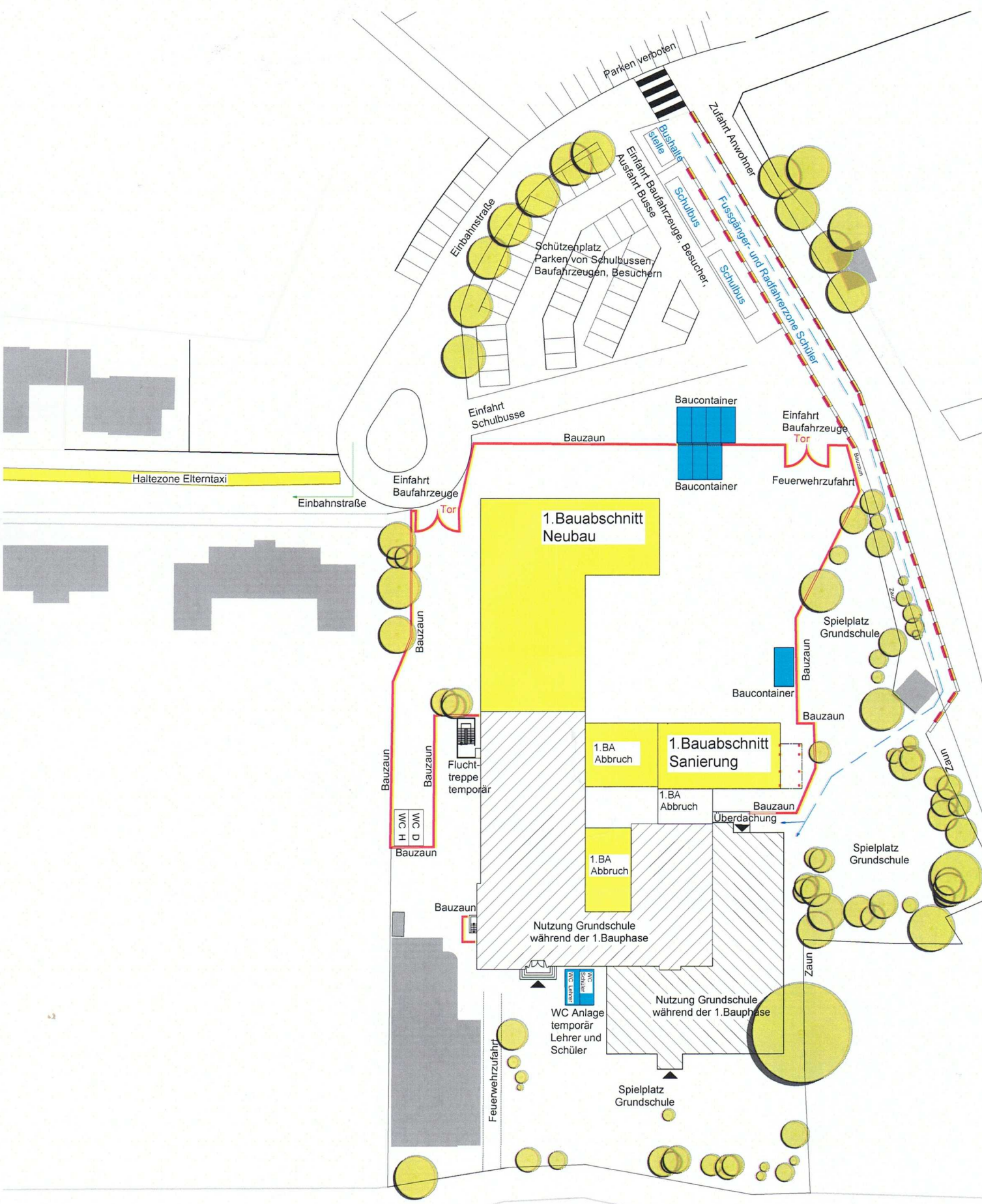
Grundschule Otterndorf - 1. Bauphase - Organisation
